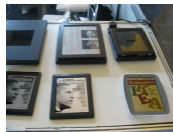
Figura 68. Detalhe dos displays da Liquavista, com a inovadora tecnologia eletro-wetting.
